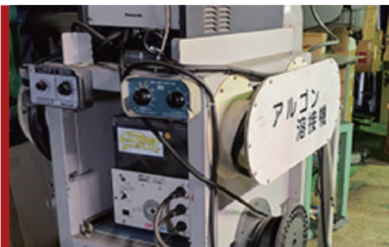
アルミ材アルゴン溶接機(手動)
