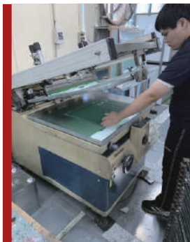
工事中黒板のシルク印刷風景
