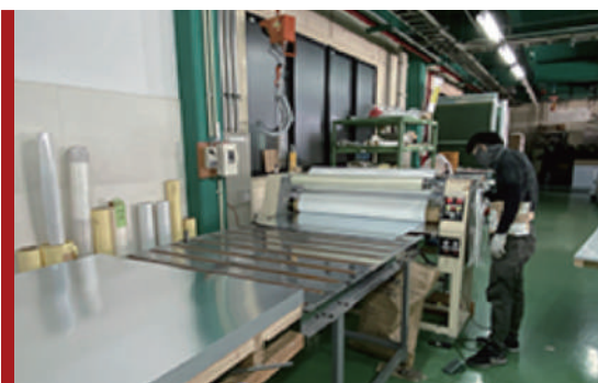
ラミネーターローラーでの反射シート貼付
