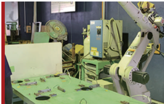
アルミ溶接自動ロボット
