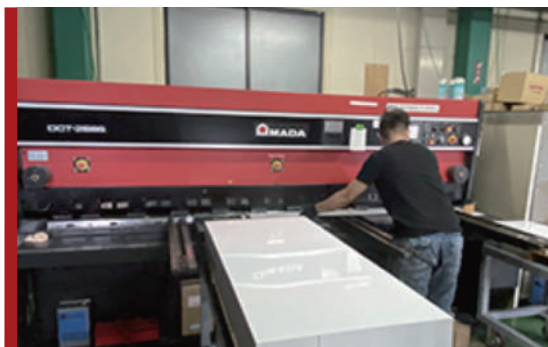
シャーリング機(鉄板及び特注サイズボードのカット) ※全長2.4mまで可能
