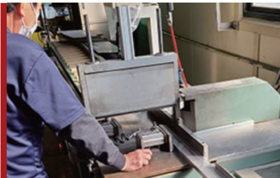
アルミ材の切断機(全長約5m可能)
